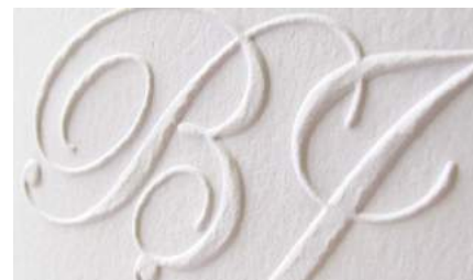
ESEMPIO DI TIMBRATURA "EMBOSSING" OTTENUTA CON UNA PRESSE DA TAVOLO
