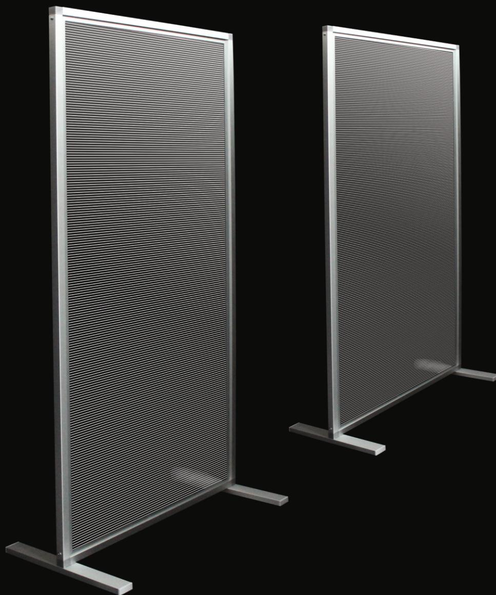
Divisorio protettivo da pavimento a schermatura totale con struttura autoportante in alluminio composta da profili quadrati su cui è fissato un pannello centrale in Policarbonato alveolare trasparente spessore mm. 4; lunghezza piedi cm. 50. Ideale per separare tavoli in bar, ristoranti, palestre, parrucchieri, sale d'attesa etc. Disponibile nelle misure: cm 75x200, 100x200, 120x200, 150x200.
