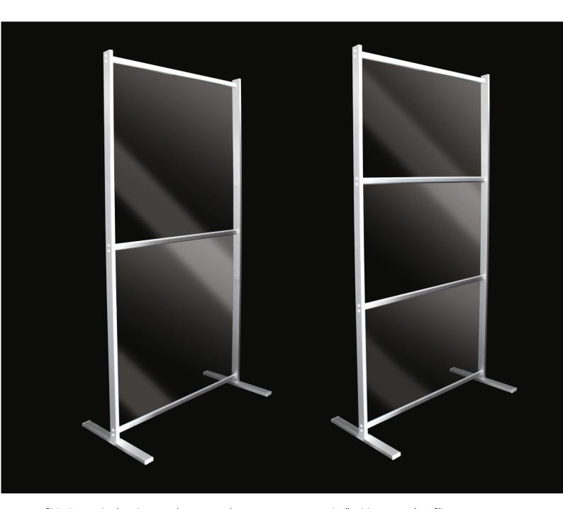
Divisorio protettivo da pavimento a schermatura totale con struttura autoportante in alluminio composta da profili rettangolari larghezza cm. 5 e traverse orizzontali su cui è fissato un pannello centrale in PET trasparente spessore mm. 1,5; lunghezza piedi cm. 50. Ideale per separare tavoli in bar, ristoranti, palestre, parrucchieri, sale d'attesa etc. Disponibile nelle misure: cm 75x200, 100x200, 120x200, 150x200.
