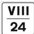
fig. 262 segnale di progressiva ettometrica
