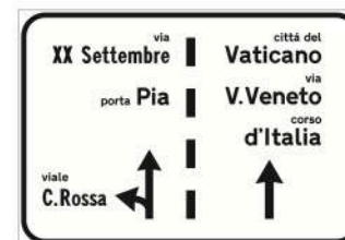
fig. 242 segnale di preselezione urbano posto sopra la carreggiata obbligatorio in pellicola cl.2
