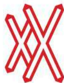
fig. 10.d doppia croce di S. Andrea installata verticalmente
