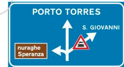
fig. 240 segnale di preavviso di intersezione extraurbana con passaggio a livello su un ramo dell'intersezione obbligatorio in pellicola cl.2
